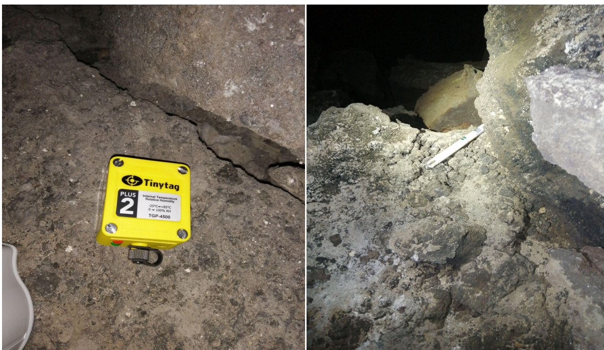
Imagen Izquierda. Medidor de Temperatura. Imagen derecha. Medidor de CO 2 y Humedad Relativa datalogger TinyTag .
