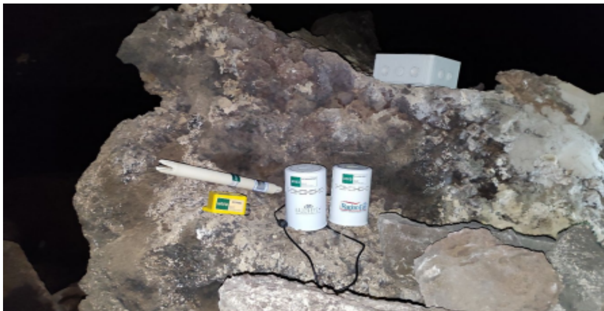
Imagen. 6 datalogger TinyTag de alta resolución de temperatura y humedad relativa,
